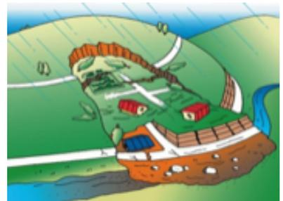
斜面の一部あるいは全部が地下水の影響と重力によってゆっくりと斜面下方に移動する現象です。
