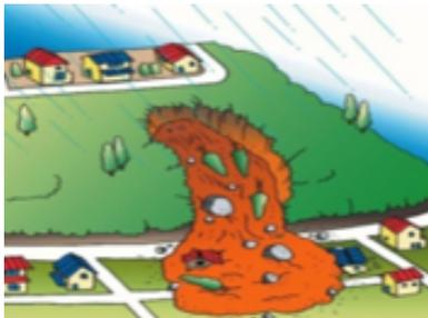
降雨時に地中にしみこんだ水分によって不安定化した斜面が急激に崩れ落ちる現象です。
