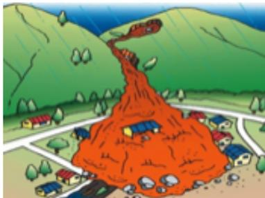
山腹・谷底にある土砂が長雨や集中豪雨などによって一気に下流へと押し流される現象です。
